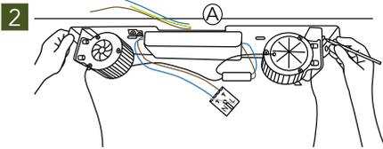
Halten Sie den Deckenbügel (A) am Montageort an. Beachten Sie, dass die Position des Deckenbügels die Ausrichtung der Leuchte bestimmt. Zeichnen Sie die Befestigungspunkte an.
