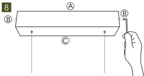
Schieben Sie den Baldachin (C) zurück auf den Deckenbügel (A) und schrauben diesen mit den Schrauben (B) seitlich wieder fest.
