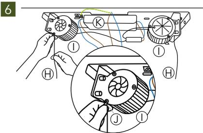
**Zur Verlängerung der Seilaufhängung (H)** lösen Sie den kleinen Bremshebel (J) unten am Rollzug (I) durch Drücken in Richtung Trafo (K) und ziehen gleichzeitig das Tragseil (H) aus dem Rollzug (I) auf die gewünschte Länge. Wiederholen Sie diesen Vorgang am anderen Rollzug (I).
