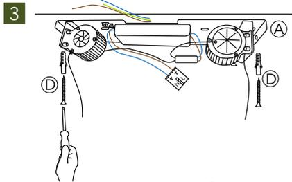
Befestigen Sie den Deckenbügel (A) abhängig vom Untergrund mittels passender Schrauben und Dübel (D). Jede Deckenbeschaffenheit hat verschiedene Anforderungen, sodass aufgrund der vielen unterschiedlich benötigten Schrauben und Dübel, diese nicht im Lieferumfang enthalten sind.
