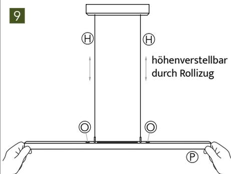
Stellen Sie die Leuchte auf die gewünschte Höhe ein indem Sie den Leuchtenkörper (P) mit beiden Händen hochschieben bzw. hinunterziehen. Prüfen Sie die Funktion der Leuchte.
