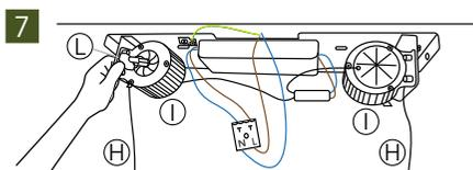
**Zum Kürzen der Seilaufhängung (H)** stecken Sie den beiliegenden Sechskant-Flügel Schlüssel (L) seitlich in den Rollzug (I) und drehen diesen so lange im Uhrzeigersinn, bis die gewünschte Länge erreicht ist. Wiederholen Sie diesen Vorgang am anderen Rollzug (I).
