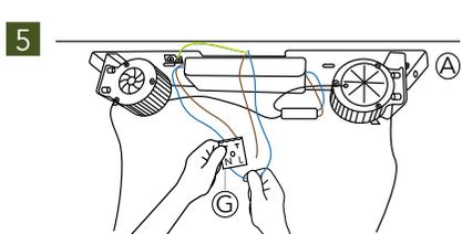
Schließen Sie die Kabel an den Stromkreis an: Stecken Sie das blaue Kabel an den N-Ausgang und das braune Kabel an den L-Ausgang von der Lüsterklemme (G).
