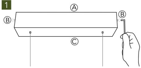
Lösen Sie die seitlichen Schrauben (B) am Baldachin (C) mit dem beiliegenden Inbusschlüssel und trennen Sie diesen vom Deckenbügel (A). Der Baldachin (C) wird auf die Seilspitzen des Leuchtenkörpers abgelegt.
