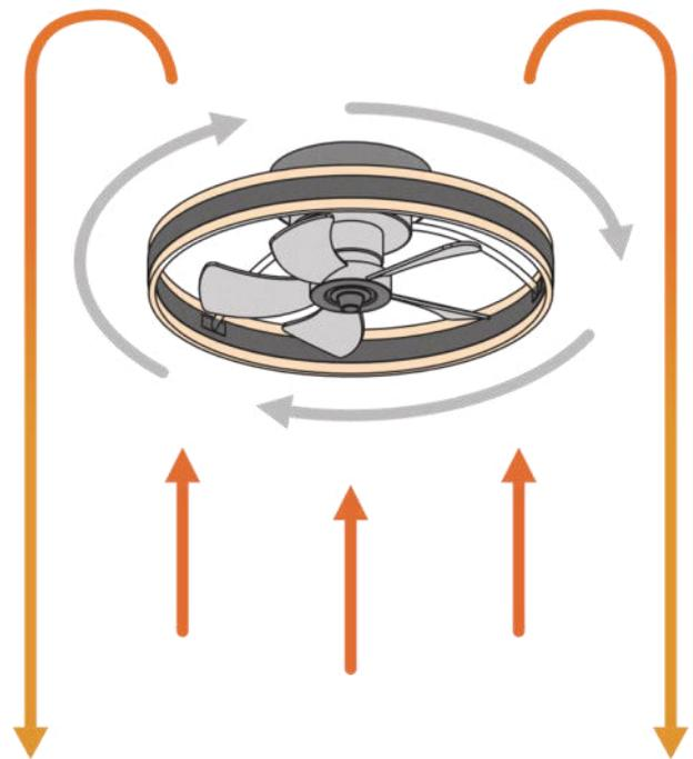
Wenn die Reverse-Funktion des Ventilators eingeschaltet wird, beginnt er sich in die entgegengesetzte Richtung zu drehen, so dass die an der Decke angesammelte warme Luft zum Boden hinunterströmt, wodurch sich der Raum im Winter erwärmt.
