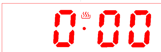
Abb. 6: Uhreinstellmodus (zweites Symbol blinkt)
