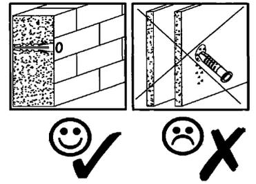
Dübel nur für Beton- oder Steinwand geeignet
