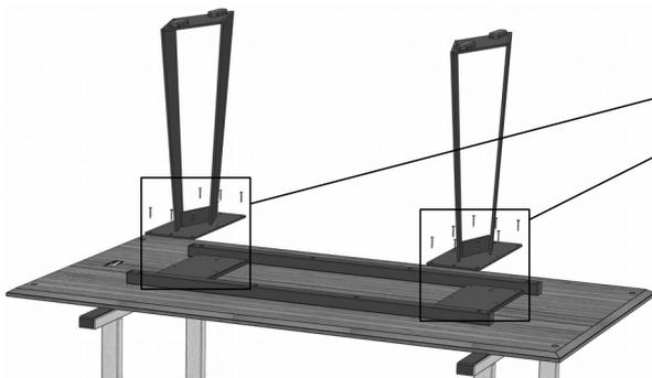
3. Die beiden Unterbauten verschrauben.
