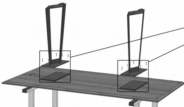
3. Die beiden Unterbauten verschrauben.
