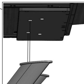
2. Den Oberbau auf den Unterbau setzen, so dass die Bohrungen von Oberbau-Halteplatten und Unterbau Gewinden fluchten.
