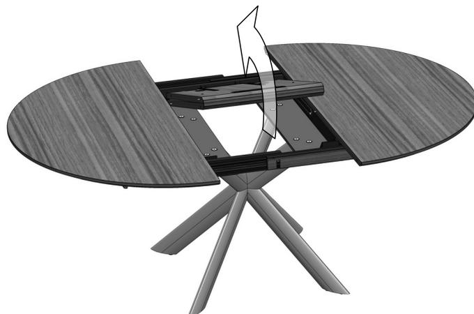
4. Beide Teile der Klappeinlage gleichzeitig hochklappen.
