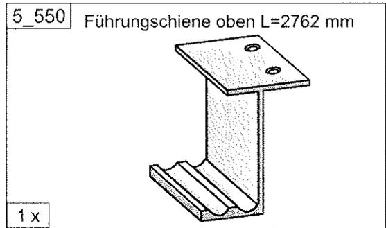
5\_550 Führungsschiene oben L=2762 mm
