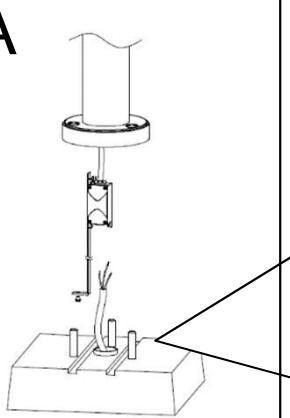
**ATTENZIONE:** I 3 perni di fissaggio nel piinto/terreno devono garantire il sicuro fissaggio dell'apparecchio.
