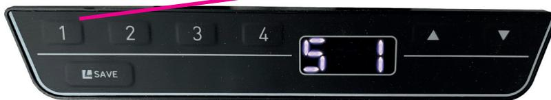
La tecla "1" para el almacenamiento del 1. altura de la prensa , Aparece "S 1". Espere 2 segundos, la altura almacenada se muestra, por ejemplo, 73 cm. Escuchará un doble clic!
