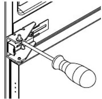
6. Schrauben Sie die obere Scharnierachse vom Scharnier ab. Drehen Sie darauf das Scharnier um und schrauben Sie die Scharnierachse ein.
