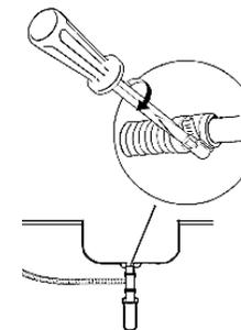
⇒ Bei einem Anschluss an einen **festen Abfluss** muss der Abwasseranschluss fest und sicher befestigt werden, um Wasserlecks zu vermeiden.
