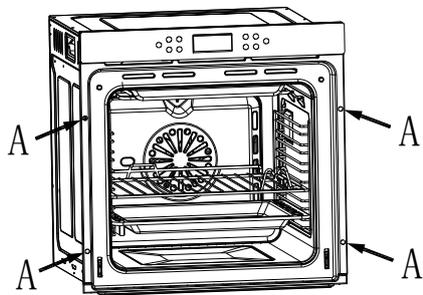
Der Ofen muss in der Einbauöffnung mit vier Schrauben sicher verschraubt werden. Diese Schrauben müssen durch das Ofengehäuse in die Wände der Einbauöffnung hineingeschraubt werden.
