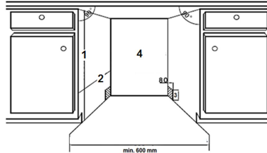
Installieren Sie das Gerät in der Einbauvorrichtung.
