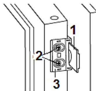
**1: Gleitelement; 2: Schrauben; 3: Führung**
