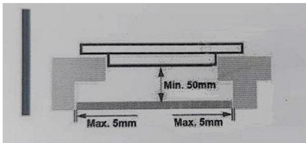
An der Außenseite des Kochfeldes befinden sich Lüftungsöffnungen. Sie MÜSSEN sicherstellen, dass diese Löcher nicht durch die Arbeitsplatte blockiert werden, wenn Sie das Kochfeld in Position bringen.
