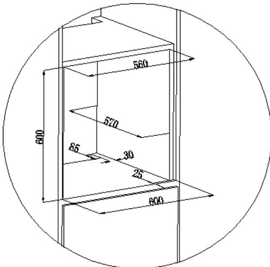
Die Abbildung zeigt die Belüftungsabstände und Belüftungsausparungen für die Installation des Geräts in einem Hochschrank.
