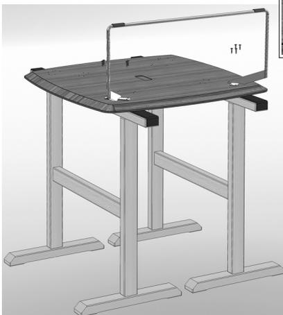
3. Den Oberbau auf gepolsterte Montageböcke legen und die Bügel verschrauben.
