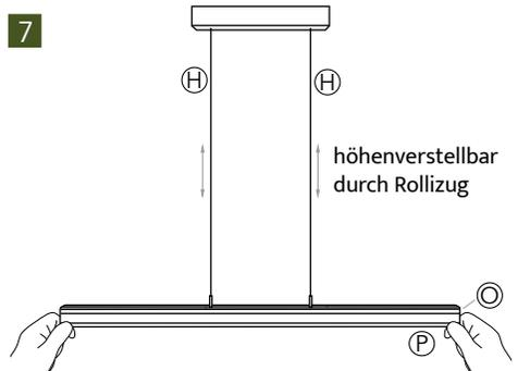
Stellen Sie die Leuchte auf die gewünschte Höhe ein indem Sie den Leuchtenkörper (P) mit beiden Händen hochschieben bzw. hinunterziehen. Prüfen Sie die Funktion der Leuchte.
