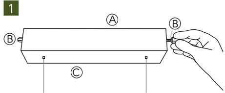
Lösen Sie die beiden seitlichen Schrauben (B) am Baldachin und trennen Sie den Baldachin (C) vom Deckenbügel (A). Der Baldachin (C) wird auf die Seilspitzen des Leuchtenkörpers abgelegt.
