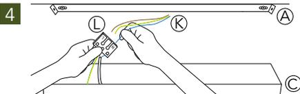
Schließen Sie die Kabel (K) an den Stromkreis an: Stecken Sie das blaue Kabel an den N-Ausgang, das braune Kabel an den L-Ausgang und das grün-gelbe Erdungskabel in die Mitte von der Lüsterklemme (L).
