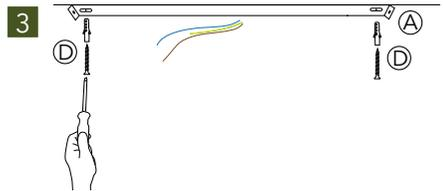
Befestigen Sie den Deckenbügel (A) abhängig vom Untergrund mittels passender Schrauben und Dübel (D). Jede Deckenbeschaffenheit hat verschiedene Anforderungen, sodass aufgrund der vielen unterschiedlich benötigten Schrauben und Dübel, diese nicht im Lieferumfang enthalten sind.
