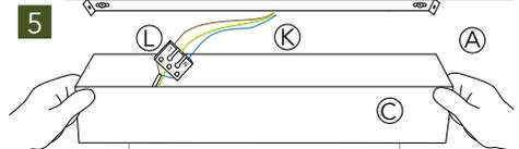
Schieben Sie den Baldachin (C) auf den Deckenbügel (A). Achten Sie darauf keine Kabel (K) einzuklemmen!
