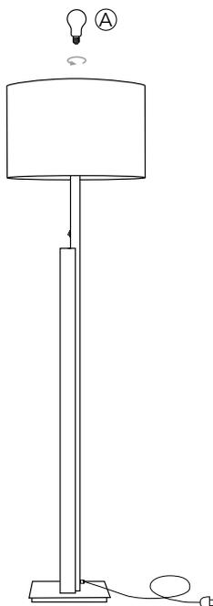
Schrauben Sie das Leuchtmittel **A** in die Fassungsaufnahme **D**. Das Leuchtmittel ist nicht im Lieferumfang enthalten. Benötigt wird 1xE27 mit max. 60 Watt.
