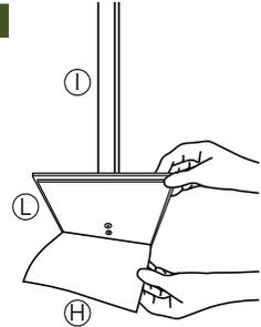
Ziehen Sie die Schutzfolie von der Moosgummimatte (H) ab und kleben Sie diese unter den Leuchtenfuß (L).
