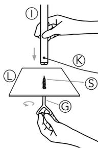
Positionieren Sie den Leuchtenkörper (I) so auf die beiden Schrauben (S), dass das Kabel (K) in Richtung des kürzeren Lochabstandes vom Leuchtenfuß (L) zeigt. Schrauben Sie die beiden Schrauben (S) mit Hilfe des beiliegenden Kreuzschraubendrehers fest (G).
