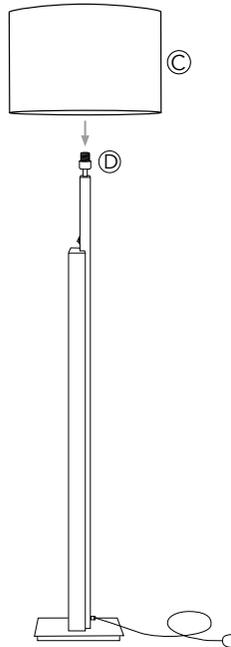
Stecken Sie den Lampenschirm (C) auf das Gewinde der Fassungs-aufnahme (D).
