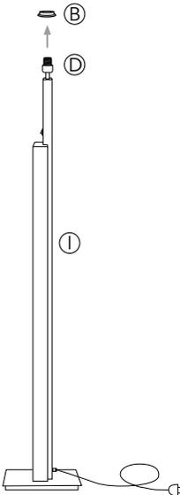
Schrauben Sie den Fassungs-schraubring (B) von der Fassungs-aufnahme (D) ab.
