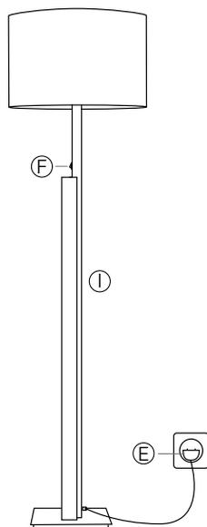
Stecken Sie den Stecker **E** in die Steckdose. Zum An- und Ausschalten betätigen Sie den Wippschalter **F** am Leuchtenkörper **I**.
