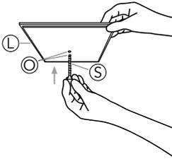
Stecken Sie die zwei Schrauben (S) durch die beiden Löcher (O) im Leuchtenfuß (L).
