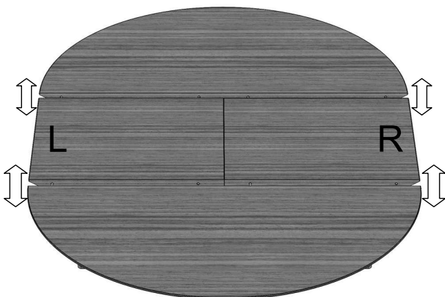
8. Prüfen, ob die Oberkanten des Auszugs und die Hauptplatten außen auf einer Höhe sind. Nur wenn nicht ... 8. Check in the middle if the upper surfaces of the boards and the extension are on one level. Only if not ...
