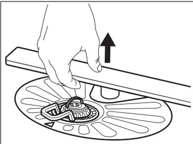
2. Reinigen Sie den Sprüharm unter fließendem Wasser. Entfernen Sie Verunreinigungen aus den Öffnungen des Sprüharms mit einem spitzen Gegenstand, z. B. einem Zahnstocher.
