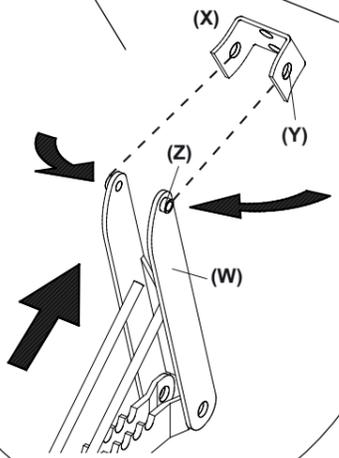
Glisser les ciseaux (W) sur le panneau (X) de façon que les trous (Y) prennent sur les boutons (Z).
