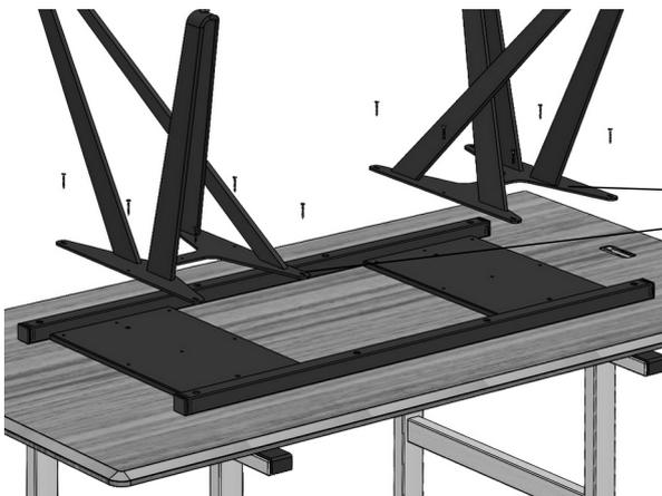
3. Die beiden Unterbauten verschrauben.
