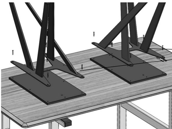
3. Die beiden Unterbauten verschrauben.
