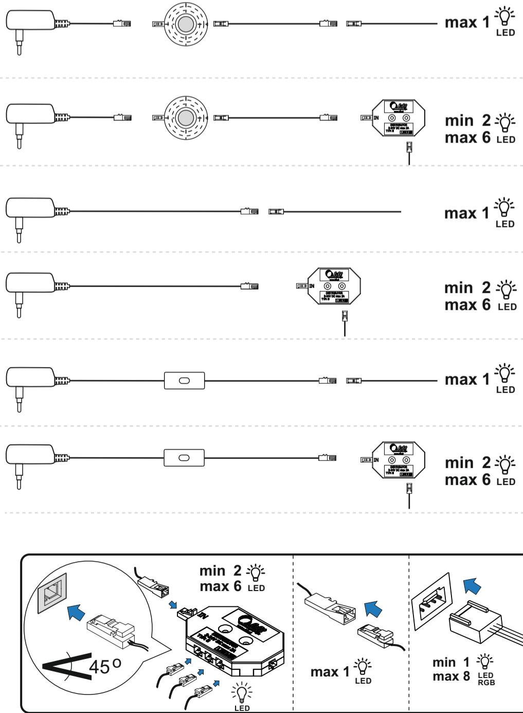
Okablowanie zasilające do oświetlenia LED / Power kit for LED lighting / Verkabelung für LED-Beleuchtung
