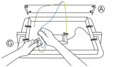
Schließen Sie das Vorschaltgerät an den Stromkreis an: Stecken Sie das blaue Kabel an den N-Ausgang und das braune Kabel an den L-Ausgang von der Lüsterklemme (G).
