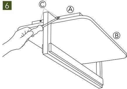
Schieben Sie den Leuchtenkörper (B) auf den Deckenbügel (A) und ziehen die vier Schrauben (C) wieder fest. Prüfen Sie die Funktion der Leuchte. Das Up- und Down-Licht ist nur zusammen schaltbar. Eine Dimmung ist über einenn externen Dimmer möglich.
