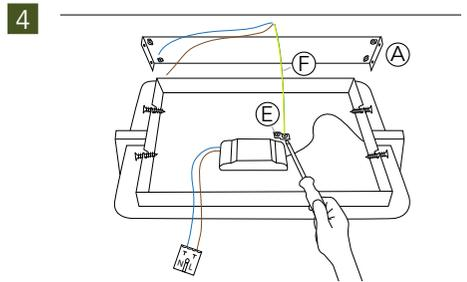
Schrauben Sie das grün-gelbe Erdungskabel (F) an die Erdlasche (E) im Deckenkasten.
