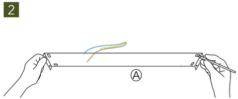
Halten Sie den Deckenbügel (A) am Montageort neben dem Kabelaustritt aus der Decke an. Beachten Sie, dass die Position des Deckenbügels die Ausrichtung der Leuchte bestimmt. Zeichnen Sie die Befestigungspunkte an.
