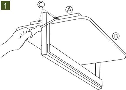
Trennen Sie den Deckenbügel (A) aus der Leuchte indem Sie die vier Schrauben (C) oben seitlich an der Leuchte mit einem Schraubendreher leicht lösen, jedoch nicht komplett abschrauben. Ziehen Sie den Deckenbügel (A) seitlich vom Leuchtenkörper (B).
