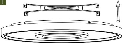
Lösen Sie die vier Schrauben an der Oberseite der Lampe vorsichtig mit einem Schraubendreher um die Deckenhalterung vom Leuchtenkörper zu trennen – drehen Sie die Schrauben jedoch nicht komplett heraus. Ziehen Sie dann die Deckenhalterung vom Lampenkörper ab. Entfernen Sie anschließend die Steuerungseinheit (Funkempfänger) vom Leuchtenkörper.
