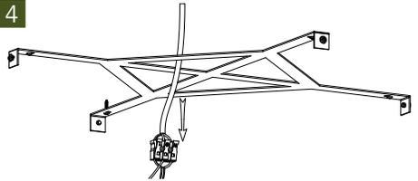
Schließen Sie die Stromkabel an den Stromkreis an: Verbinden Sie das blaue Kabel mit dem N-Ausgang (Neutral-/Nulleiter) der Lampenanschlussklemme, das braune Kabel mit dem L-Ausgang (Phase) und das gelb-grüne Kabel an den mittleren PE-Anschluss (Schutzleiter).
