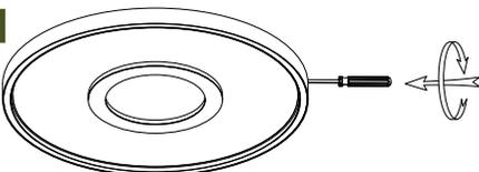
1. Drehen Sie den Leuchtenkörper so, dass er die Schraubenpositionen des Deckenhalters erreicht.
