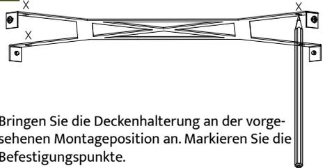
Bringen Sie die Deckenhalterung an der vorgeesehenen Montageposition an. Markieren Sie die Befestigungspunkte.
