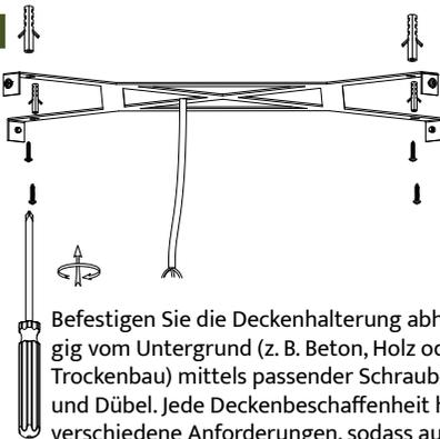
Befestigen Sie die Deckenhalterung abhängig vom Untergrund (z. B. Beton, Holz oder Trockenbau) mittels passender Schrauben und Dübel. Jede Deckenbeschaffenheit hat verschiedene Anforderungen, sodass aufgrund der vielen unterschiedlich benötigten Schrauben und Dübel, diese nicht im Lieferumfang enthalten sind.
