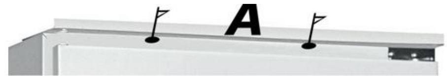
Befestigungspunkte zum Fixieren des Gerätes durch die bereits fertig montierten Bauteile A+B und den mitgelieferten Holzschrauben in der Einbaunische.
