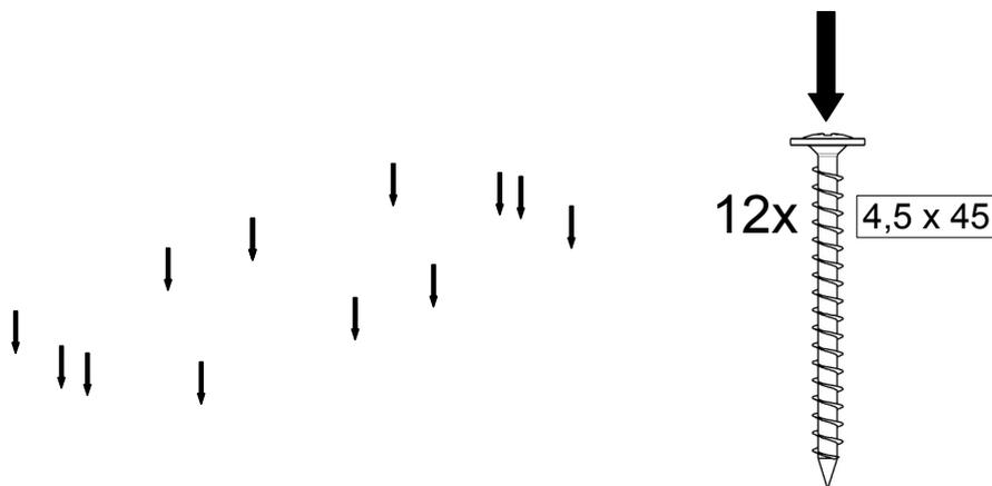
4. Die Trägerplatte des vormontierten Unterbaus nun wieder an den Oberbau schrauben. Auch die zusätzlichen Spax-Schrauben eindrehen.
