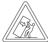
**T6** Die Schrankaufhänger dienen zur Kippsicherung des Schrankes und müssen grundsätzlich montiert werden.
