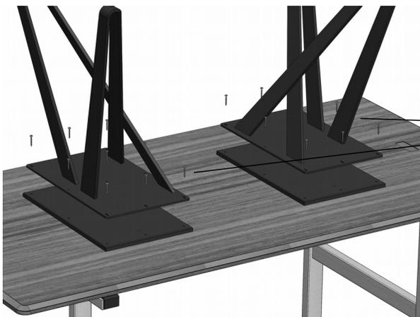
3. Die beiden Unterbauten verschrauben.
