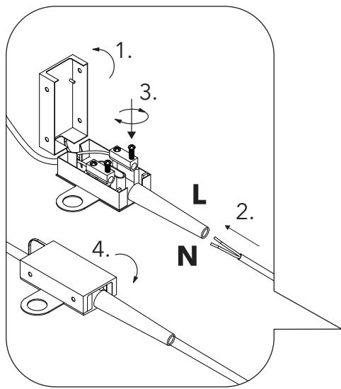
Weißen Kabelschutz vorsichtig mit Schlitzschraubenzieher öffnen.
