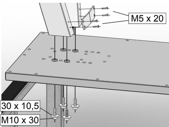
3. Die Bolzen der Tischbeine in die im Bild gezeigten Löcher stecken. Jeden Bolzen mit mit einer Unterlegscheibe und einer Mutter fixieren.
