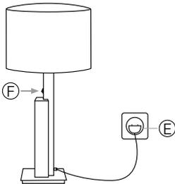
Stecken Sie den Stecker (E) in die Steckdose. Zum An- und Ausschalten betätigen Sie den Wippschalter (F) am Leuchtenkörper.
