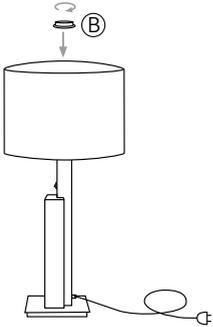
Schrauben Sie den Fassungserschraubring (B) wieder auf die Fassungsaufnahme (D).
