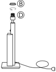
Schrauben Sie den Fassungserschraubring (B) von der Fassungsaufnahme (D) ab.
