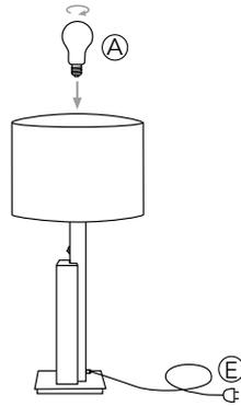
Schrauben Sie das Leuchtmittel (A) in die Fassungsaufnahme (D). Das Leuchtmittel ist nicht im Lieferumfang enthalten. Benötigt wird 1xE27 mit max. 60 Watt.
