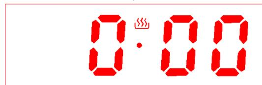
Drücken Sie die Taste „ $\textcircled{M}$ “ wieder 3 Sekunden lang. Der Ofen wird abgeschaltet und wechselt in den Standby-Modus. Das Display blinkt wie in Abb. 6 zu sehen.
